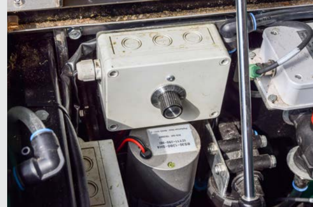
Het waterdebiet van de sproeiers is onder de kap eenvoudig terug te brengen of op te schroeven.
