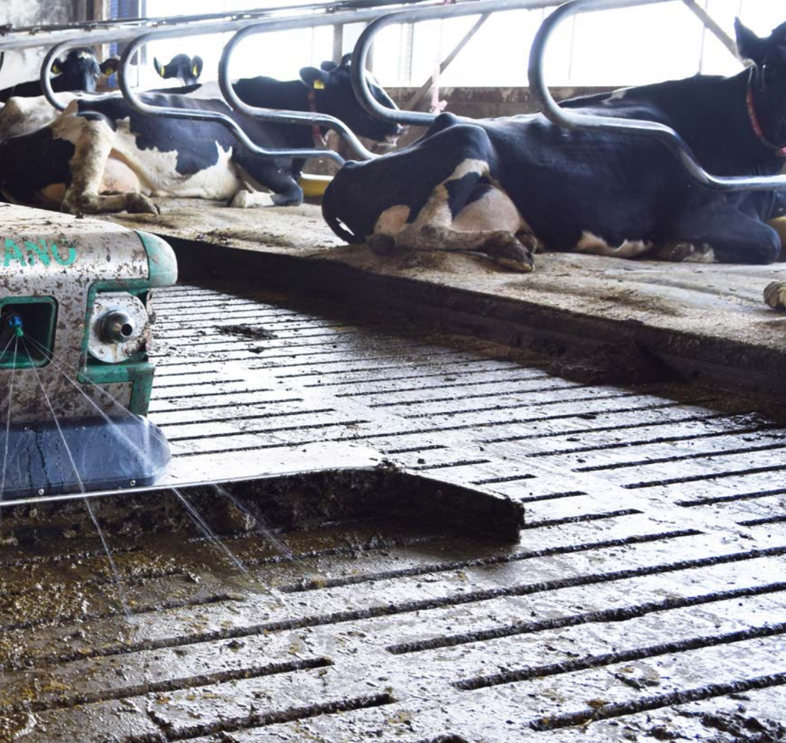
Het waterdebiet van de sproeiers is onder de kap eenvoudig terug te brengen of op te schroeven.
