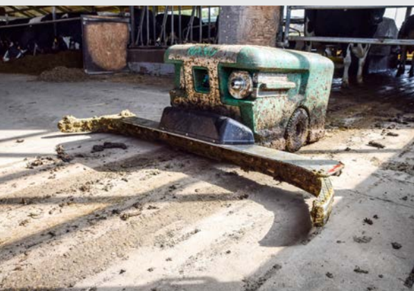
Bij een voergang drukt de Nano een glijstof op de vloer, waardoor de schuif van de grond komt.
