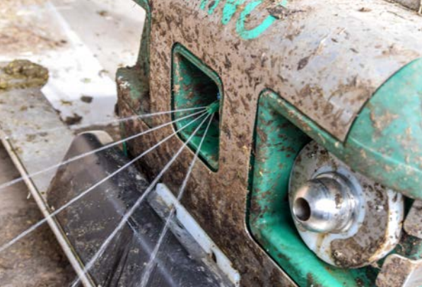
Optie is een sproei-installatie die de vloer voor en/of na het schuiven natmaakt.
