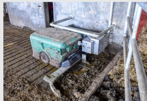
Bij het rvs-laadstation worden de accu's opgeladen en wordt het waterreservoir bijgevuld.
