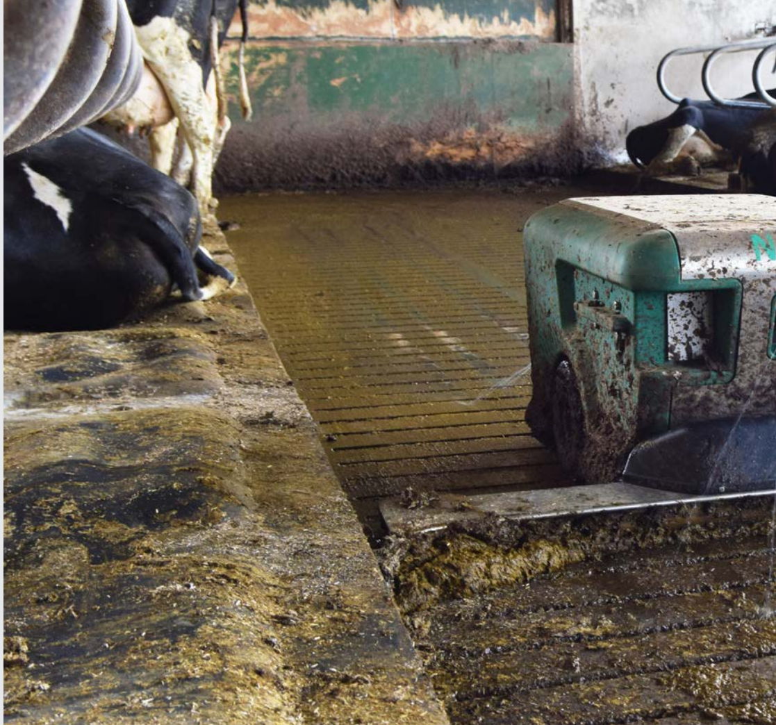
Bij een voergang drukt de Nano een glijstof op de vloer, waardoor de schuif van de grond komt.
