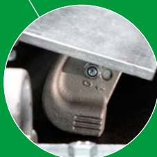
Verschleißindikatoren an Füßen statt Hauptrahmen
